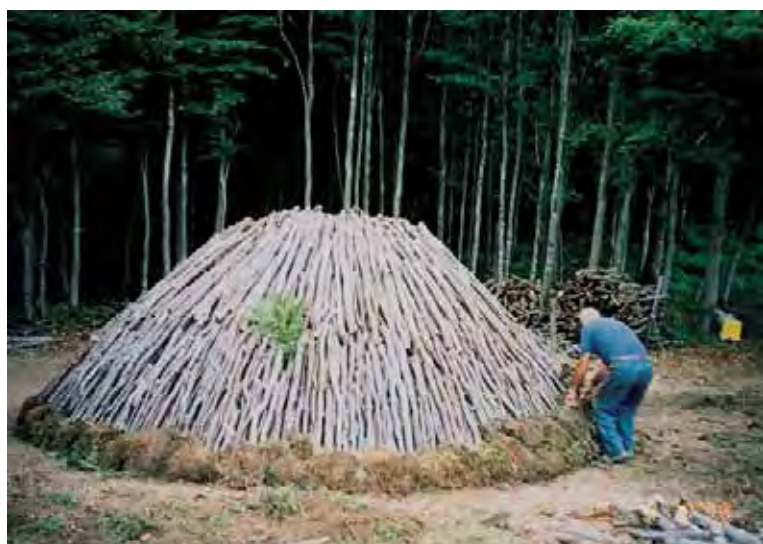
Le Banditacce (Fattoria "Il Passeggere" - 11 agosto 1999). Allestimento di una carbonaia - 1° fase: la legna viene predisposta a forma di cono, su due livelli, in modo da lasciare al centro un'apertura con funzione di camino; poi viene accuratamente ricoperta di zolle. (fotografia di Leandro Gualtieri).
